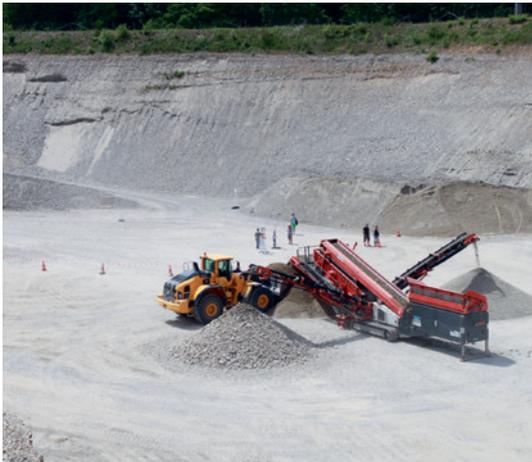
Pneulader und Kiessortieranlage
